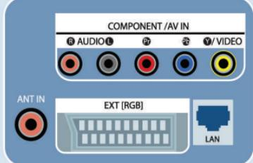
↑ Разъем для подключения антенны на цифровом телевизоре
