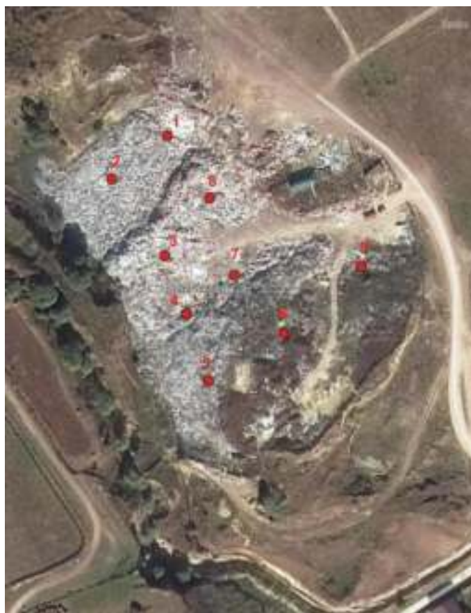
Рисунок 3.9.9.1 – Расположение точек шпурового опробования и измерения эмиссии биогаза на территории несанкционированной свалки в с. Первомайское
